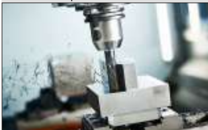
Fresatura di spallamenti
